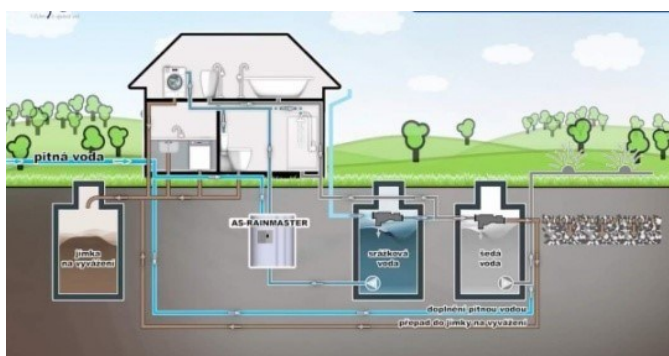
System recyklácie šedej vody
